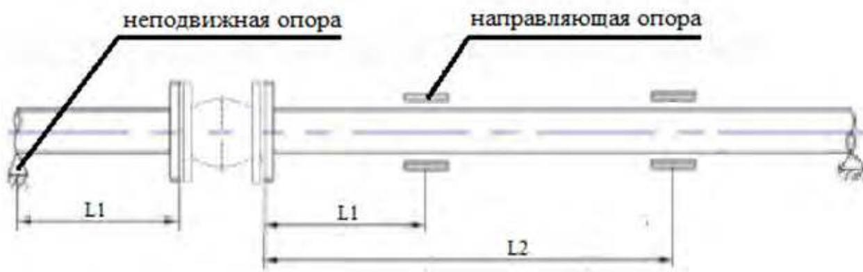
2.1.10. При монтаже компенсатора необходимо использовать воротниковые фланцы. **Монтаж компенсатора на плоские фланцы, плоские свободные фланцы или иные отличные от воротниковых фланцев запрещён!**
